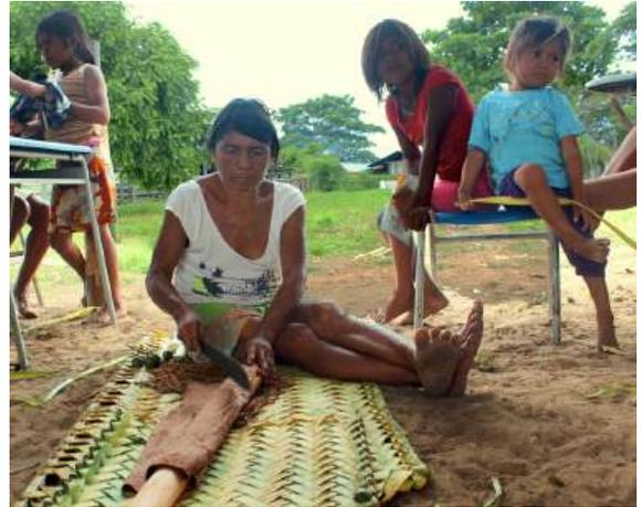
Cuando ya se ha retirado la corteza, aún falta despegar la fibra de la madera. Para ello se debe golpear la fibra a lo largo de la vara con el borde sin filo del machete alternando la orientación del mismo, primero diagonalmente con la mano derecha y luego con la izquierda. Las direcciones opuestas de los golpes del machete dan un aspecto de tramado en la fibra, y garantiza que ella se vaya adelgazando y desprendiendo de la madera de manera uniforme y sin que se rompa.
